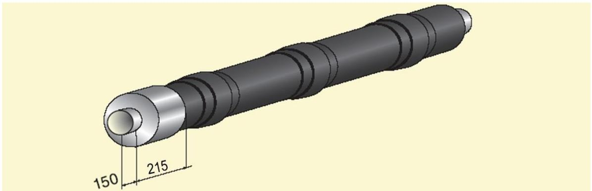
**Пример заказной спецификации** стальной трубы наружным диаметром 426 мм, толщиной стенки 7 мм, с изоляцией типа 1 из пенополиуретана с усиленной полиэтиленовой оболочкой, с металлической заглушкой изоляции длиной 215 мм: труба с усиленной оболочкой и металлической заглушкой изоляции Ст 426х7-1-ППУ-ПЭ-Б-215. ГОСТ 30732.
